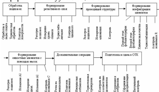
Рисунок 6. Технологический маршрут изготовления тонкопленочной резистивно-емкостной микросхемы комбинированным методом
