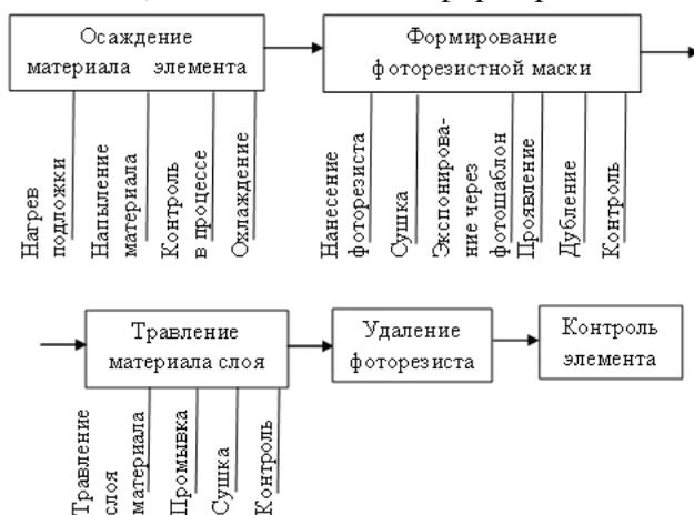
Рисунок 3. Технологический маршрут последовательности изготовления тонкопленочного элемента фотолитографией.
