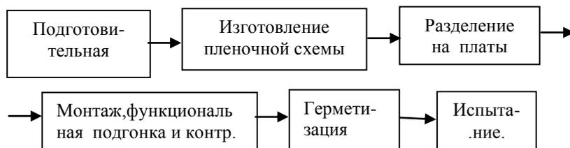
Рисунок 2. Основные этапы технологического процесса изготовления тонкопленочных ГИС и МСБ
