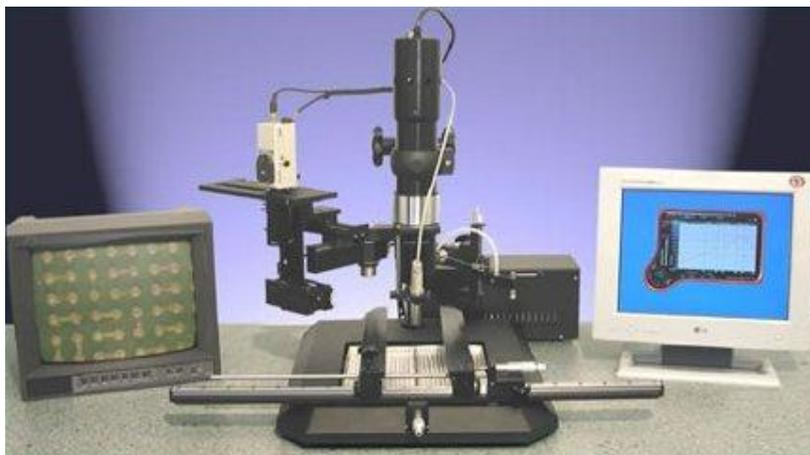
**Рис. 7.7.** Паяльно-ремонтный центр IR-X410
