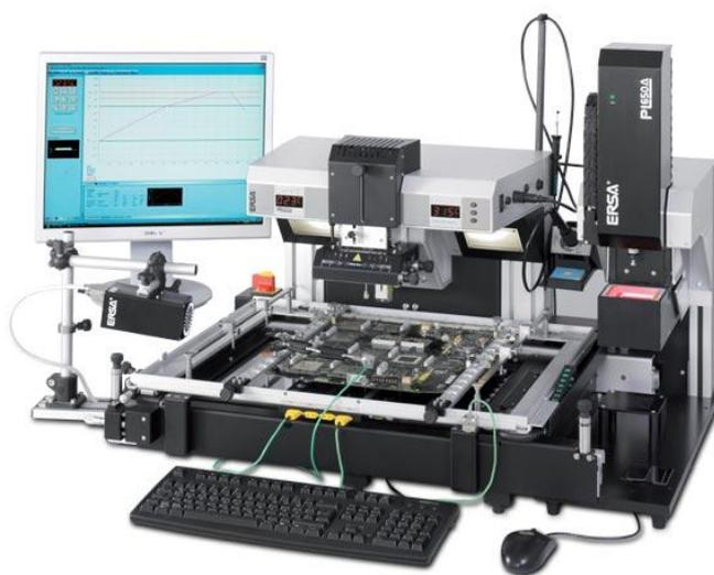
**Рис. 7.35.** Универсальная паяльно–ремонтная станция IR/PL 650
