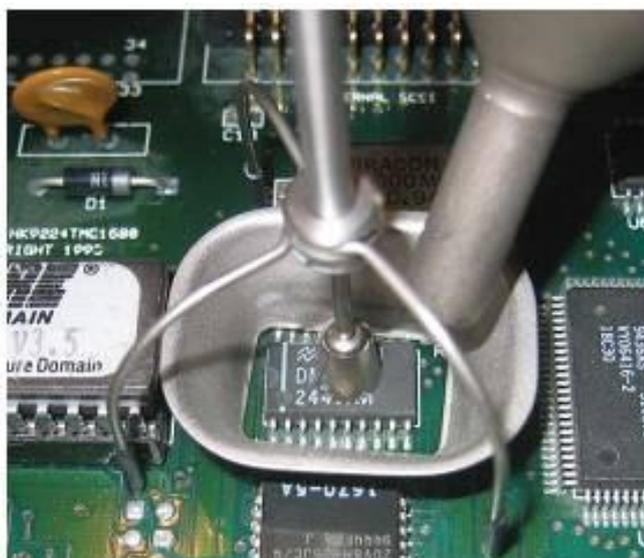
**Рис. 7.28.** Пайка ИС с помощью термофена и рассекателя потока
