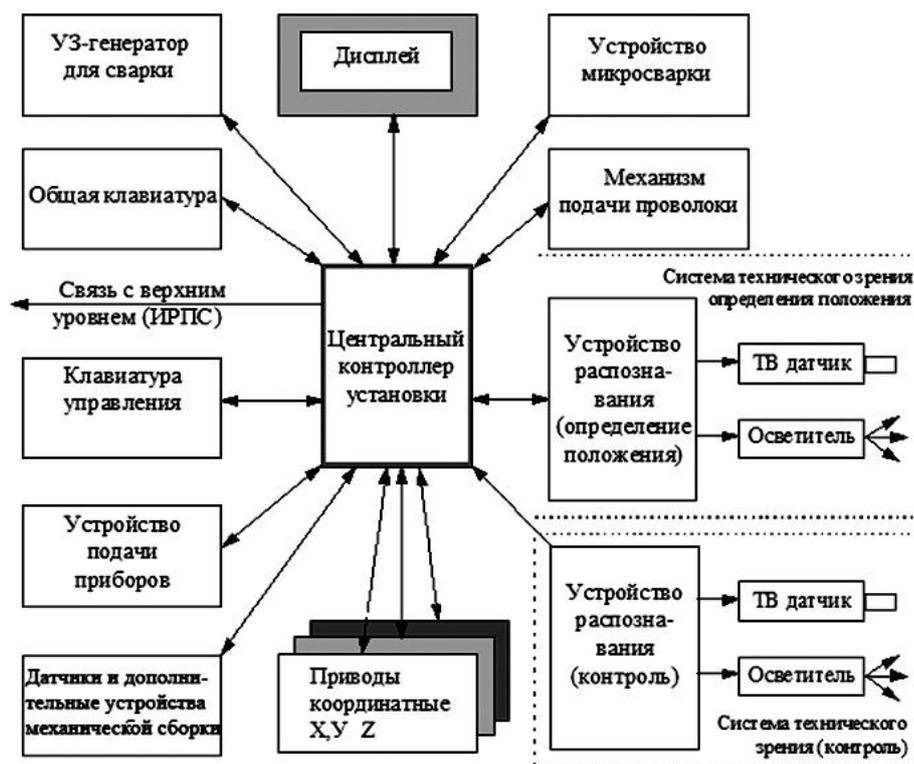
Рис. 10.15. Структурная схема установки УЗ проволочных выводов
