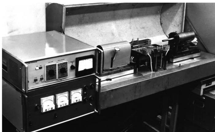
**Рис. 8.21.** Схема (а) и установка (б) УЗ бесфлюсовой пайки подложек ГИС
