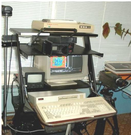
**Рис. 12.2.** Тепловизионная система Thermovision 880
