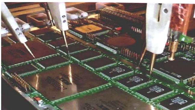
**Рис. 12.6.** Система летающих пробников для электрического контроля соединений
