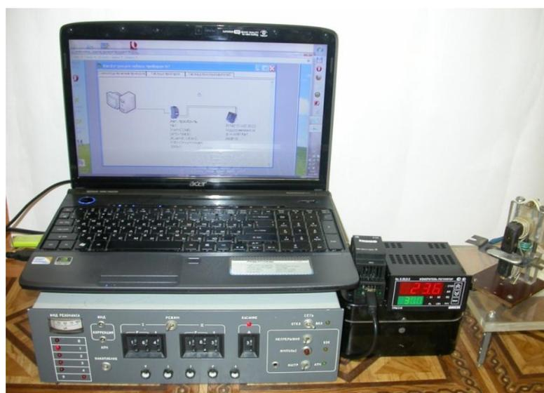
**Рис. 6.34.** Рабочее место исследования индукционного нагрева в зазоре магнитопровода
