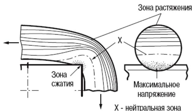
**Рис. 11.1.** Напряжения и деформация в зоне сжатия провода в накрутке
