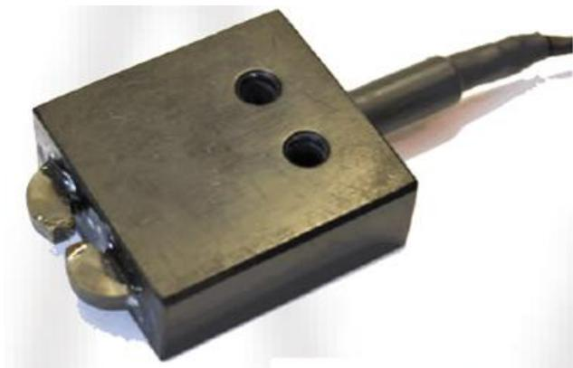
**Рис. 6.32.** Индукционное устройство на незамкнутом магнитопроводе
