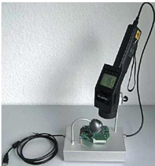
**Рис. 6.44.** Крепление пирометра Optris LS на штативе для обеспечения минимального пятна измерения
