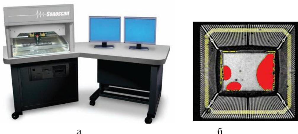
**Рис.12.29.** Цифровой акустический микроскоп D9500 Sonoscan (а) и акустическое изображение микросхемы в пластиковом корпусе
