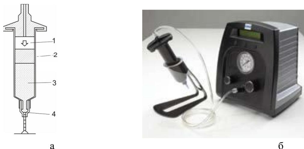
**Рис. 5.8.** Схема дозирования паяльной пасты (а) и ручной дозатор (б):
