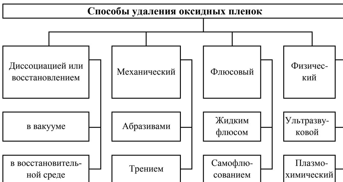
**Рис. 4.5.** Классификация способов удаления оксидных пленок
