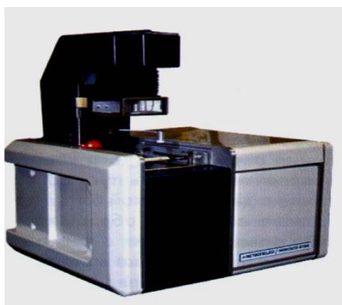
**Рис. 3.13.** Тестер контроля паяемости Menisco ST88
