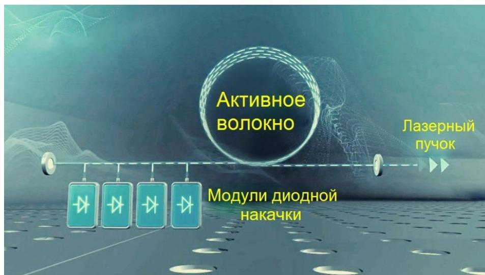
**Рис. 6.53.** Схема волоконного лазера с диодной накачкой
