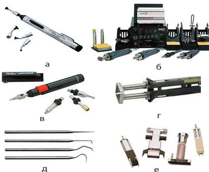
**Рис. 7.34.** Оснастка для демонтажа компонентов: вакуумный пинцет (а), паяльная станция (б), газовая горелка (в), термофен с двумя соплами (г), пинцеты (д), насадки для термофена (е)
