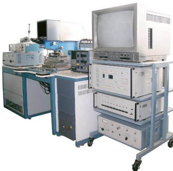
**Рис. 12.33.** Лазерный фотоакустический комплекс
