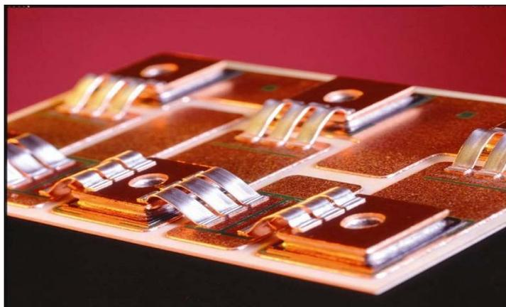
**Рис. 10.5.** Соединения ленточными перемычками в силовых приборах
