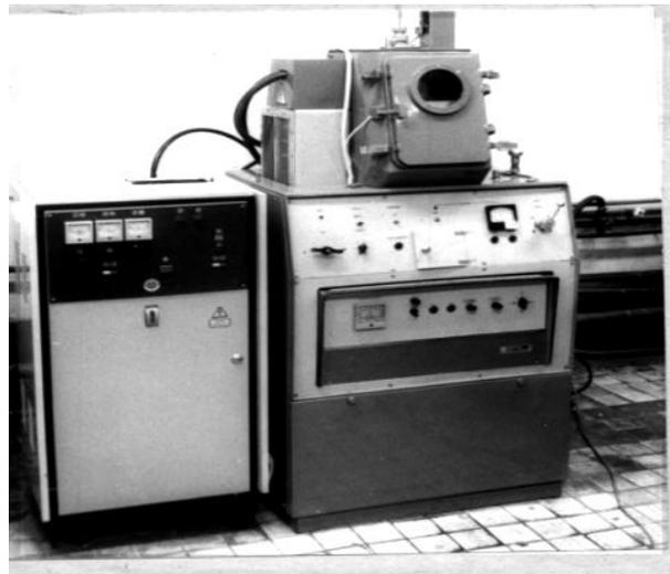
**Рис. 2.6.** УЗ установка получения порошка припоя
