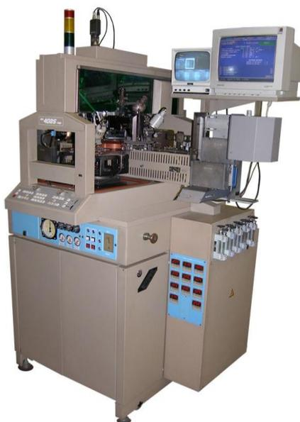
**Рис. 9.7.** Автомат присоединения кристаллов ЭМ-4085-14М
