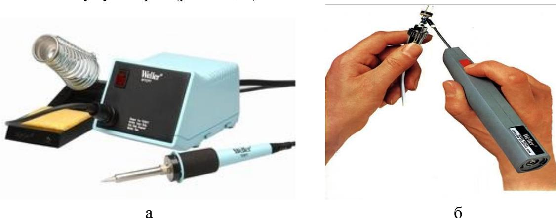
**Рис. 7.4.** Паяльная станция (а) и работа с паяльником без шнура (б)
