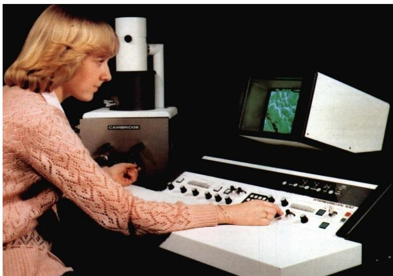
**Рис. 12.13.** Растровый электронный микроскоп Stereoscan-360
