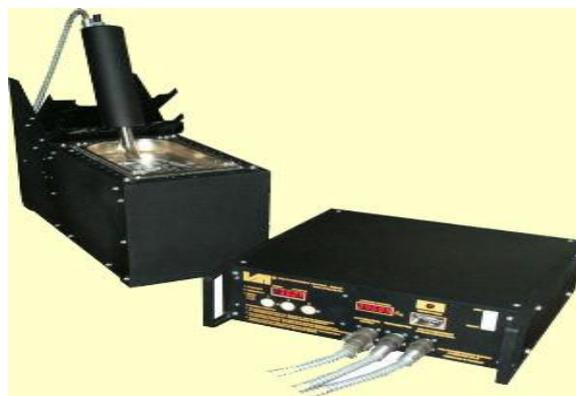
**Рис. 8.17.** Схема локального ввода ультразвука в расплав (а) и установка УЗ пайки (б): 1– преобразователь, 2–волновод, 3–деталь, 4– расплав, 5 – нагреватель
