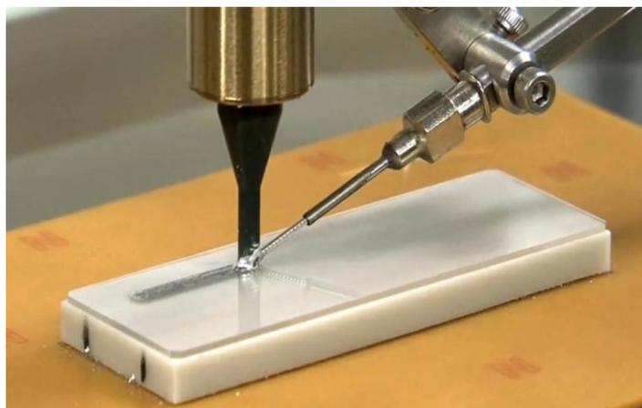
**Рис. 8.31.** Устройство локальной автоматической УЗ металлизации
