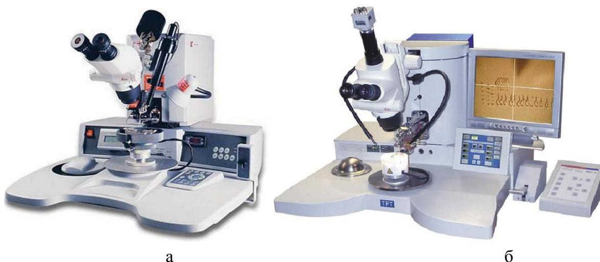
**Рис. 10.19.** Установки термозвуковой сварки мод.4524AD K&S (а) и HB16 TPT (б)
