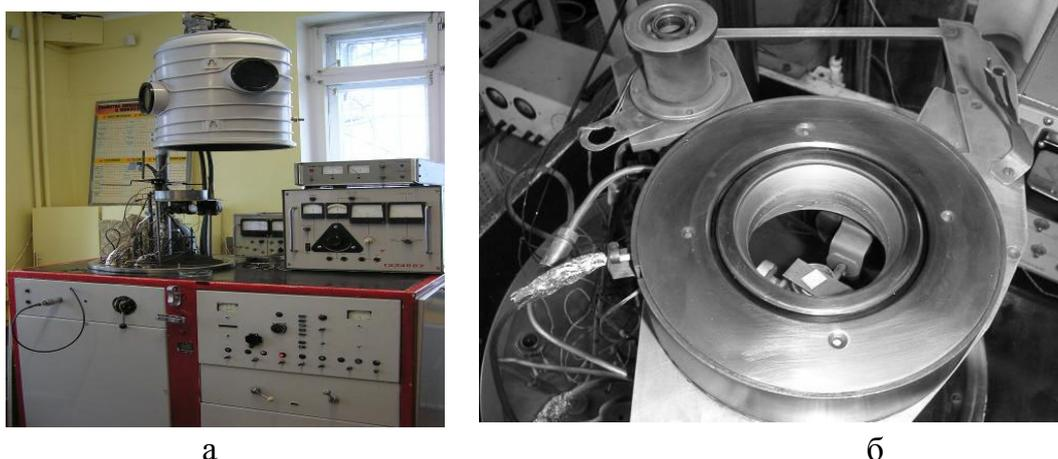
**Рис. 8.34.** Вакуумная установка (а) и устройство ионно-лучевой пайки (б)
