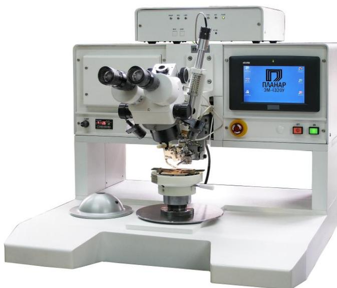
**Рис. 10.18.** Универсальная установка микросварки ЭМ-4320У
