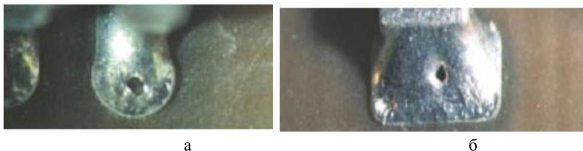
Рис. 12.27. Пустоты (а) и раковины (б) в паяных соединениях
