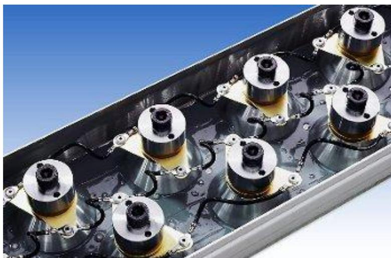
**Рис. 5.13.** Расположение УЗ преобразователей на вибропанели
