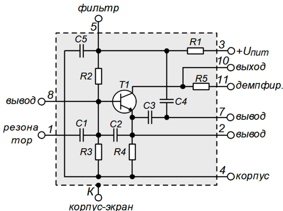
Каскад на транзисторе T1 собран по схеме «ёмкостной трёхточки». Конденсаторы C2 и C3 элементы обеспечивающие запуск генератора на первой гармонике кварцевого резонатора.
