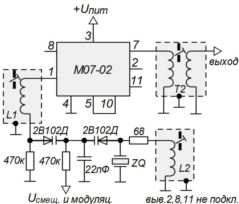
Выходной контур включает в себя катушку индуктивности с подстройкой, а также ёмкости С3 и С4 внутри микросхемы. Выход генерации через катушку связи.
