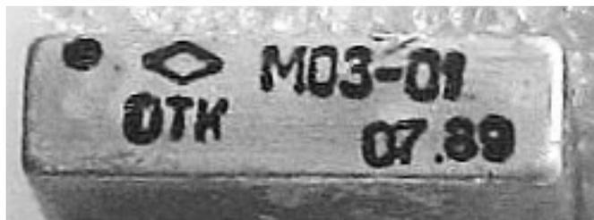
**Назначение:** шумоподавитель для приёмника радиостанции.
