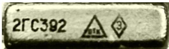
**Назначение:** генератор сигнала тонального вызова.
