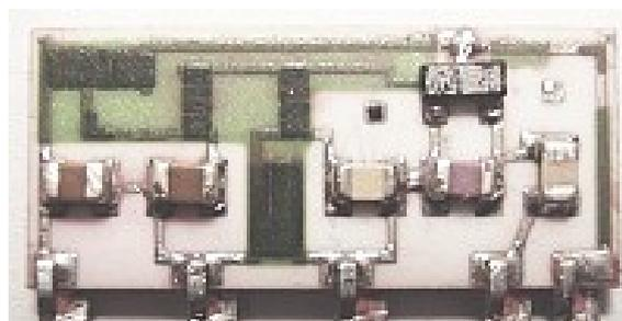
Вариант выполненный на керамике по толстоплёночной технологии
