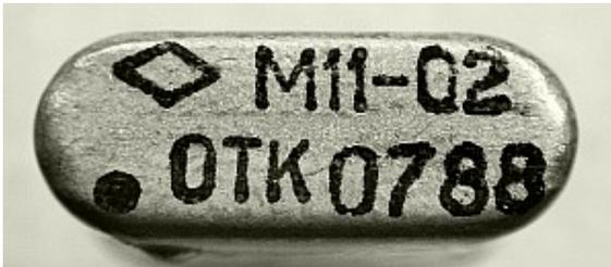
**Назначение:** усилитель ВЧ повышенной мощности для каскадов передатчика.
