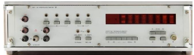
Digitalvoltmeter G-1210.010, geeignet für Temperaturmessungen mit Thermoelementen, VEB Funkwerk Erfurt
