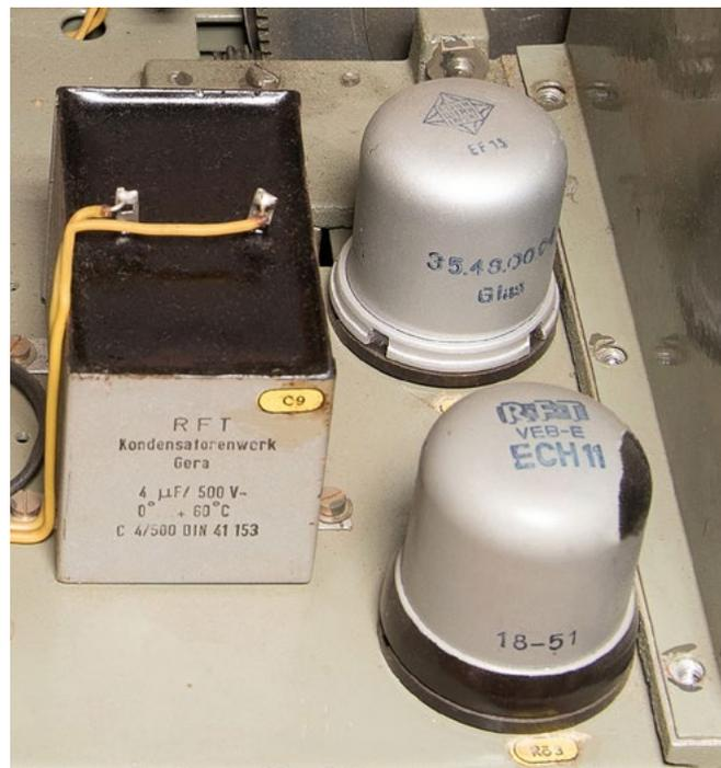
Thüringer Beiträge: rechts die Röhren ECH 11 und EF 13, links ein Metallpapier-Kondensator aus dem Kondensatorenwerk Gera zum Glätten und Stabilisieren der Anodenspannung, Foto: G. Roleder
