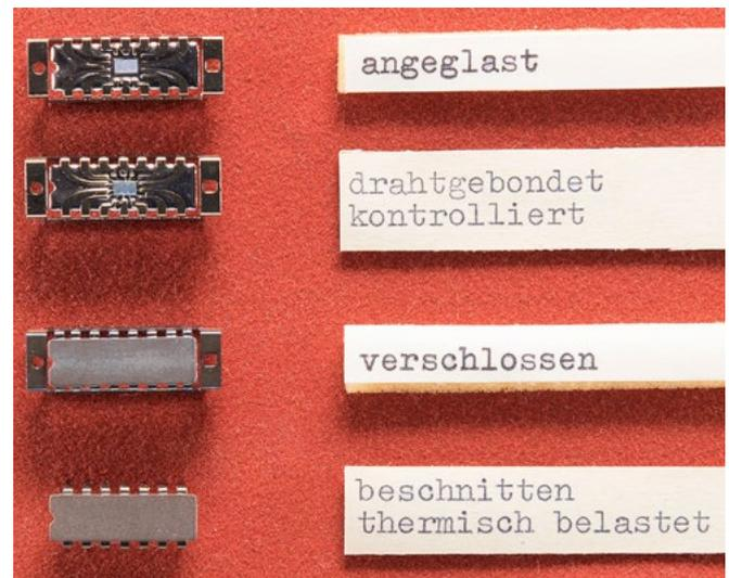
Einige Montage-Schritte der Herstellung von Schaltkreisen im Keramik-Gehäuse (Zyklus 2)
