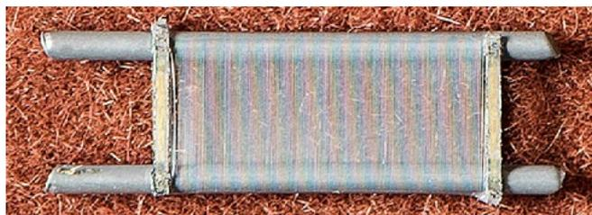
Spangitter einer HF-Pentode EF 183; die bewickelte Fläche ist etwa 5 x 10 mm groß (Foto: Autor)
