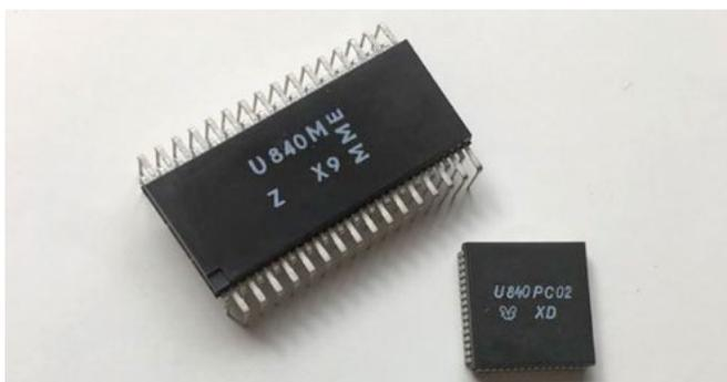
Zwei Gehäuseformen des Schaltkreises U840 - links Quad-Inline Plastikgehäuse U840M und rechts Chip Carrier Plastikgehäuse U840PC,
