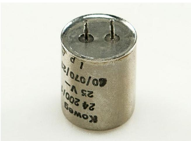
Druckglasdurchführung eines Wickelkondensators mit Polystyrol-Dielektrikum (EM)
