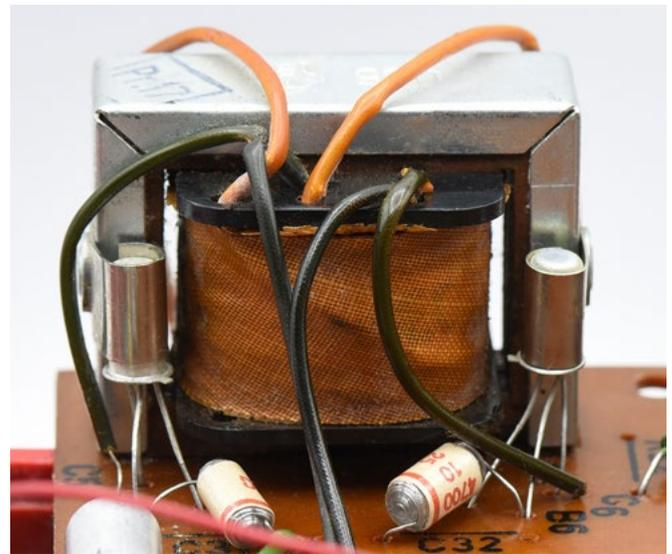
Beim „Stern Party“ sind die Endstufen-Transistoren des Typs GC 121 mit Kühlfahnen am Metallrahmen des Ausgangsübertragers befestigt (EM)
